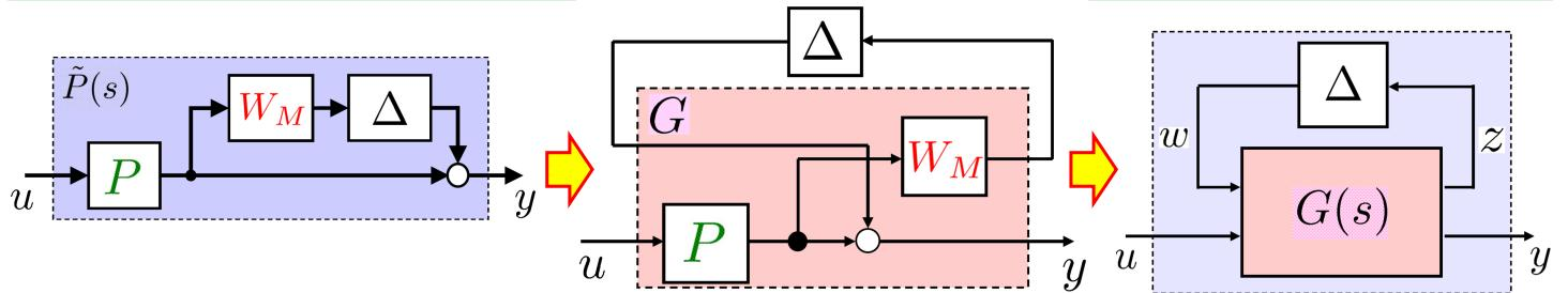
$$w = \Delta z, \quad \|\Delta\|_\infty \leq 1 \quad \begin{bmatrix} z \\ y \end{bmatrix} = G(s) \begin{bmatrix} w \\ u \end{bmatrix} = \begin{bmatrix} G_{11}(s) & G_{12}(s) \\ G_{21}(s) & G_{22}(s) \end{bmatrix} \begin{bmatrix} w \\ u \end{bmatrix}$$
